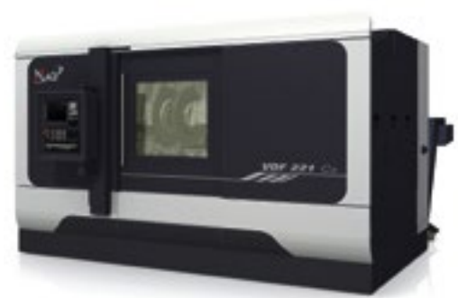
Die neue Maschinenbaureihe VDF 221 zur Kurbelwellenfertigung.
